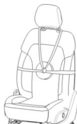
图15 靠背调节耐久试验
