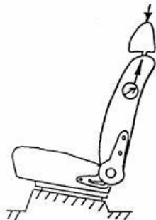
图 10 头枕锁止强度试验
